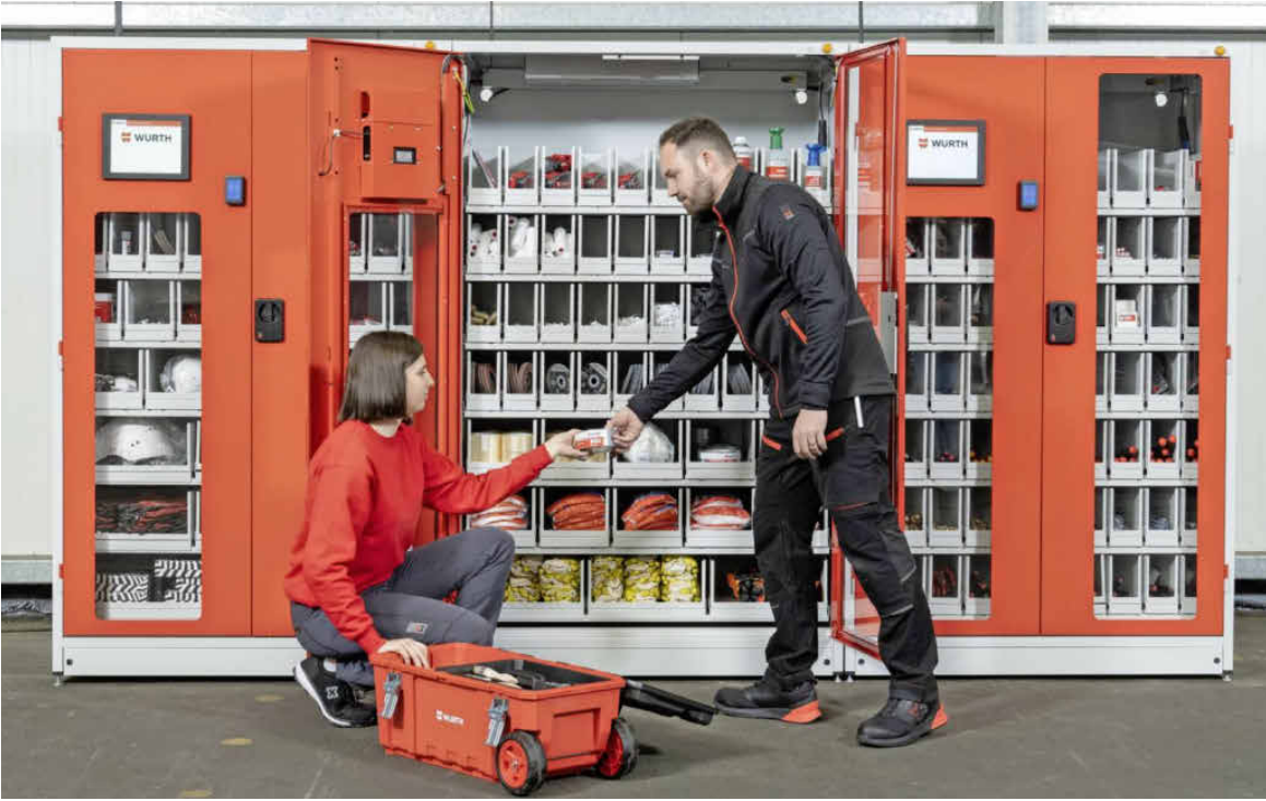
Der ORSYmat WGT erkennt über integrierte Wiegezellen, wenn Artikel entnommen wurden, und bestellt sie automatisch und transparent nach. Foto: Würth/Peter Petter
