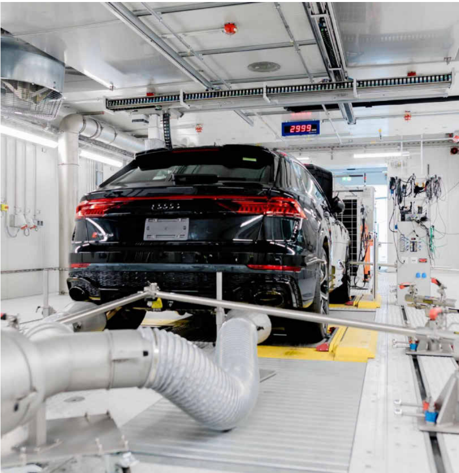
In der Klimahöhenkammer von Audi in Neckarsulm herrschen je nach Testbetrieb Temperaturen von 30 Grad unter Null bis zu 55 Grad über Null. Foto: Audi
