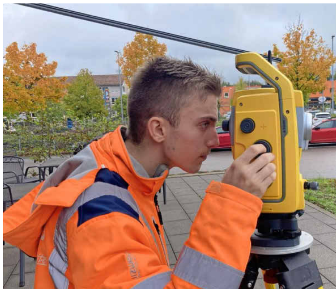
Das Tachimeter ist eins der wichtigsten Geräte für einen Vermessungstechniker. Foto: Anna-Linda Hahn
