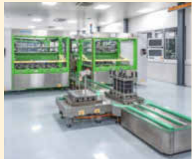
Auf dieser Anlage werden Elektrolyse-Stacks produziert. Foto: privat
