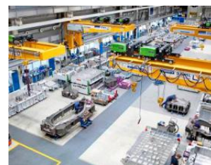
Vier Konsolkrane mit Hebezeugen von STAHL CraneSystems.
