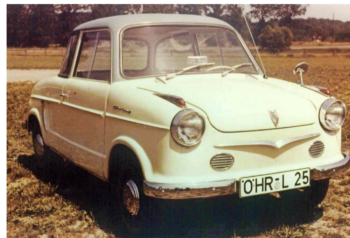
Der NSU Prinz ist damals eine moderne zweitürige Limousine mit selbsttragender Ganzstahlkarosserie und Heckmotor.
