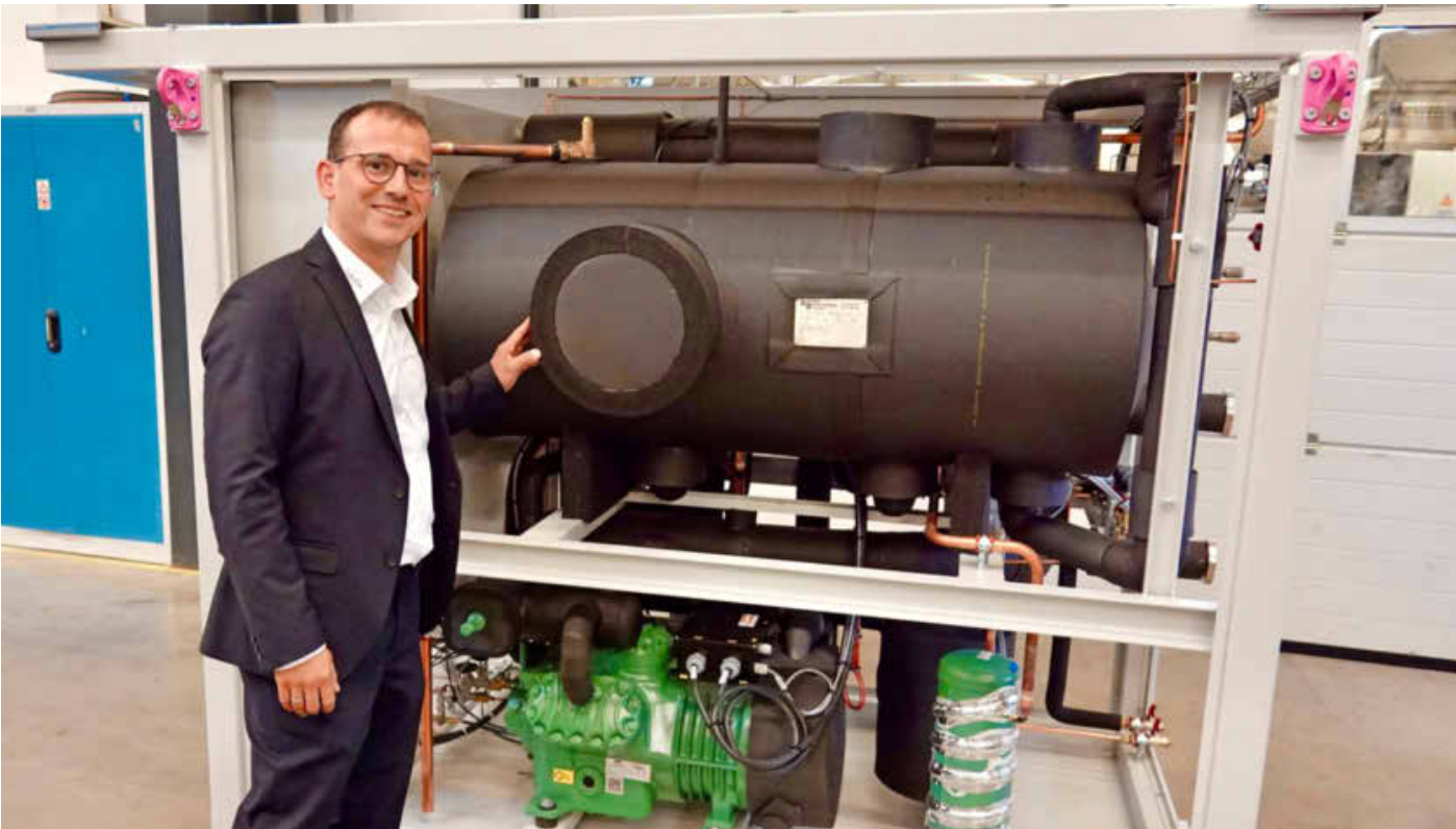
Jasper Laug treibt beim Temperierspezialisten Lauda das Thema Wasserstoff voran. Hier steht er an einer Kühleinheit für Wasserstoff-Tankstellen. Gut eingepackt in schwarze Isolierung ist der Kühlmittelbehälter. Foto: Christian Gleichauf
